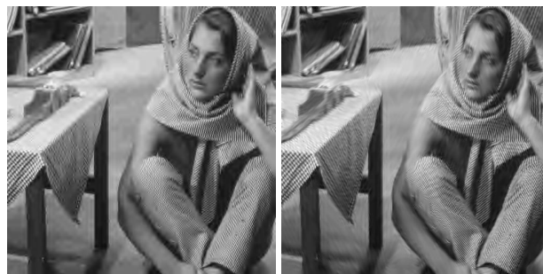
Figure 5 – [gauche] Codage de l'image barbara 512x512 par ondelette 9/7 séparable sur 3 niveaux à 0.3 bits/pixel, PSNR = 26.93 dB. [droite] Codage par ondelette 9/7 orientée sur 6 niveaux à 0.3 bits/pixels, PSNR = 27.87 dB. La bande basse est à la même résolution dans les deux cas.
